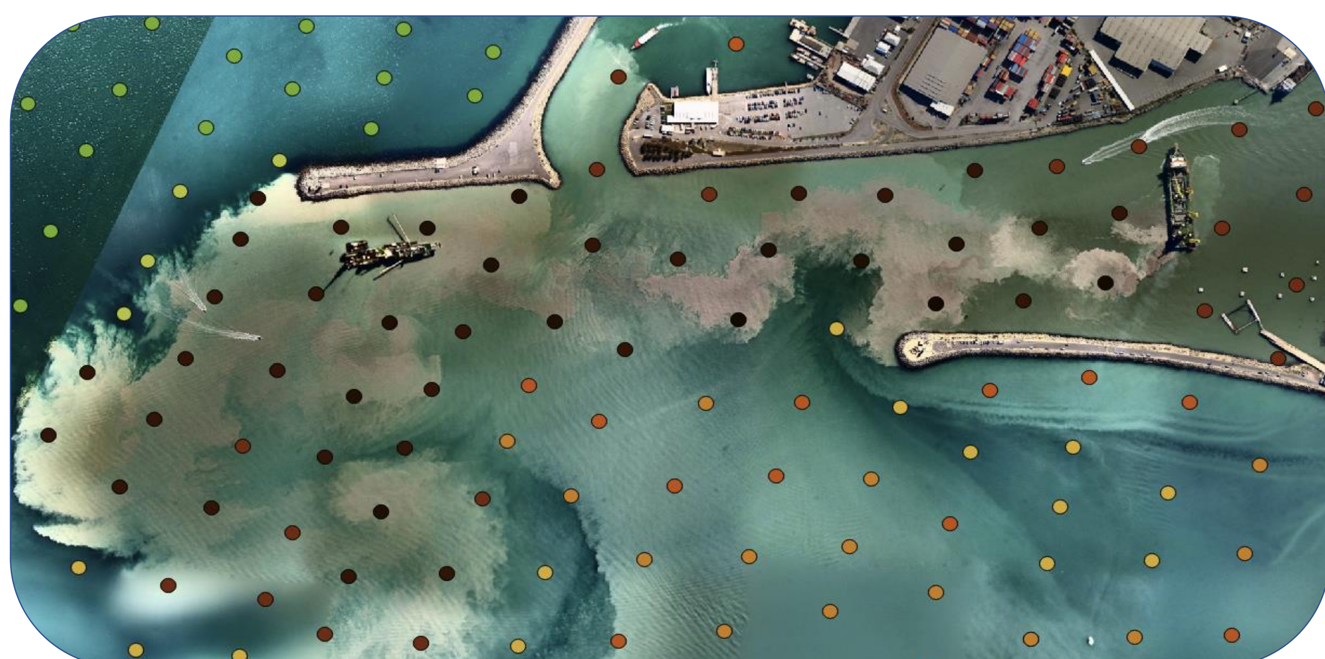
Vue aérienne d'un chantier de dragage avec dépôt où chaque point correspondrait à une bouée Secchi 2.0
